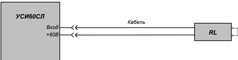
Рис. 13. Схема непосредственного контроля целостности кабеля.
