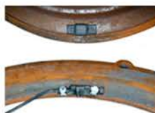
Датчики ДАК-1 и ДАК-2 устанавливаются на край чугунного люка в полость между рёбрами жёсткости крышки и кольцом люка
