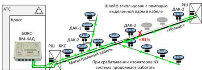
Комплексная защита системы от КЗ и обрыва
